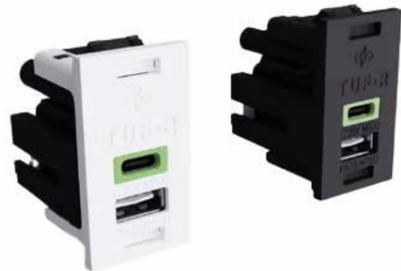
Mit seiner kleinen Form eignet sich QF **TUF-R®/HP** perfekt für die Integration in Möbel. In Kombination mit unserem 70-W-Netzteil bietet QF **TUF-R®/HP** eine Lieferung von bis zu 60 W vom Typ C USB, ideal für Laptops, und bis zu 12 W vom Typ A USB, ideal für Telefone und Tablets.
