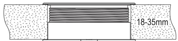
Legen Sie den ARC80 in einen  $\text{Ø}80\text{mm}$ -Ausschnitt und ziehen Sie den Befestigungsring von Hand in der Position fest, die der Dicke Ihrer Oberfläche am besten entspricht.
