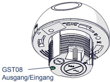
Canister Base mit Canister PSU & GST08 Ausgang/Eingang
