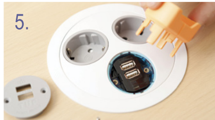
Setzen Sie den zweiten Teil des TUF-Austauschwerkzeugs ein, bis ein Klicken zu hören ist (4 Clips rasten in die TUF Einheit ein).
