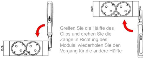
Achten Sie darauf, dass die Module beim Entfernen der Verriegelungsclips nicht beschädigt werden.
