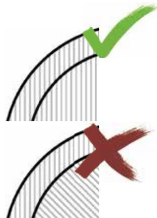
Beim Einbau einer gebürsteten Edelstahlausentülle, darauf achten, dass die Maserung der Richtung der Maserung der Innenabdeckung folgt.
