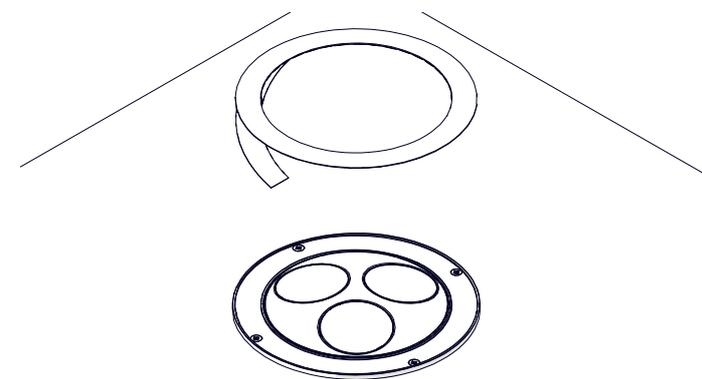
Um die äußere Abdeckung zu montieren, entfernen Sie die VHB-Abdeckung, an der äußeren Tülle ausrichten und dann fest nach unten drücken.
