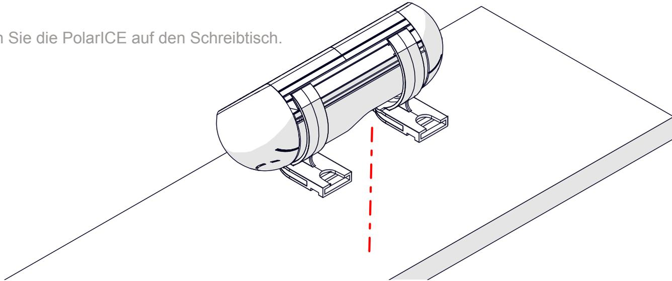
2 Setzen Sie die Befestigungsklammern ein.
