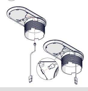
PIXEL in die ARC-G-Durchführung einsetzen
